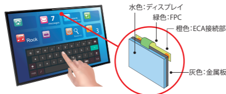
ディスプレイのグラウンド接続 Display ground connection.
