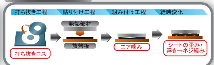
必要な形状に打ち抜くため、打ち抜きロスが生じる。また圧縮の不具合によりエア噛みやシートの歪み・浮きが生じ、密着性が低下する可能性がある。
